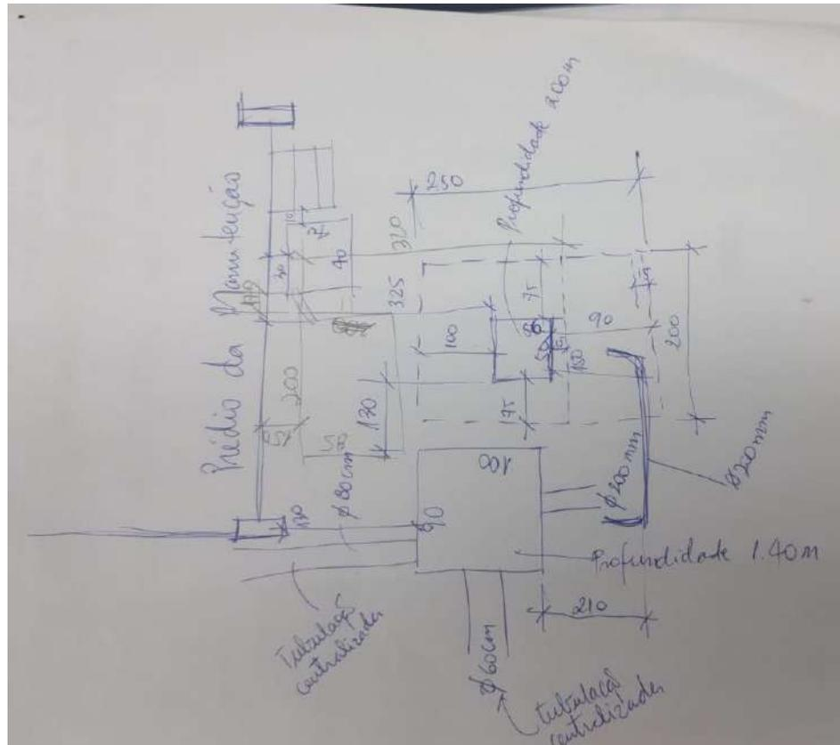
Foi possível fazer as medições, identificar os pontos de entrada, saída e caixas de passagem ligadas a fossa. Com essa informações foi elaborado um croqui esquemático que baseará a digitalização em dwg e inclusão no arquivo utilizado como base para os projetos de instalações do campus.
